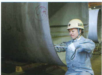
材料、寸法、塗装、溶接など各工程の検査を実施し、書類申請などを行う仕事。職場で誰も持っていない資格を取得するといった努力が自信に繋がっている
